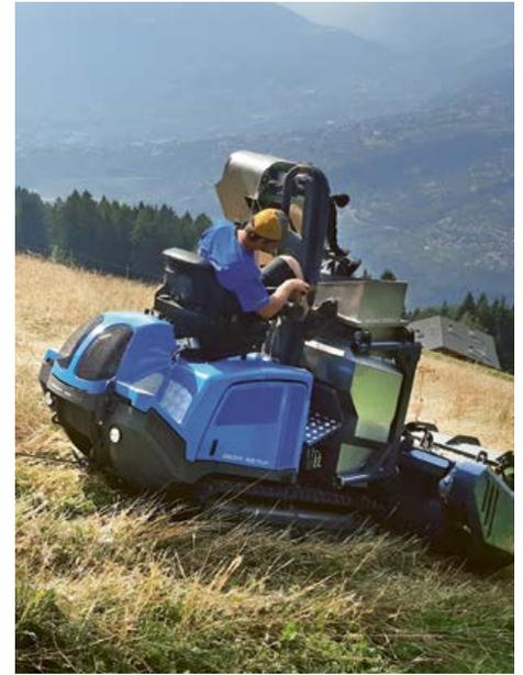
Südtiroler Know-How: der Prototyp einer Erntemaschine für Steillagen. Das Raupenfahrzeug hängt an einer Seilwinde.
